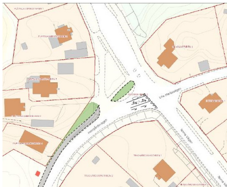
Principskiss, breddning och vägvisningsmarkeringar i vägbanan vid utfart från Herrgårdsvägen mot Norra vägen.
