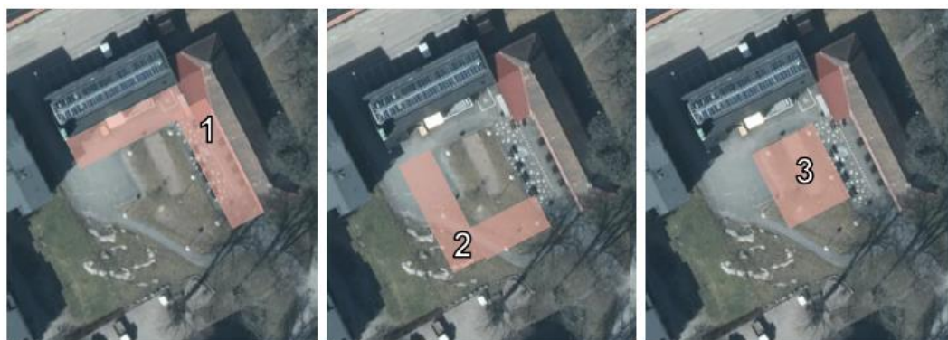
Figur 10. Urklipp ur Kulturmiljöutredning (Radar, 2023). Karta över innergården med tre principer för placering av tillbyggnad/inglasad uteservering. 1. I anslutning till befintlig bebyggelse. 2. Tillbyggnad placeras för att gränsa av och rama in innergården. 3. Tillbyggnad placeras mitt på gården.
