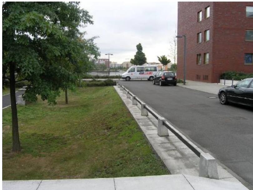
Figur 22: Exempel på en torrdamm i anslutning till en väg. Foto: WRS, 2022
