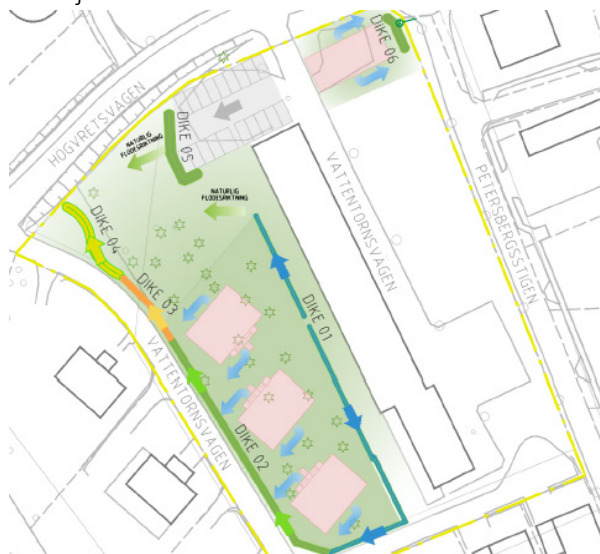
Förslag till utformning av dagvattenhantering med diken
