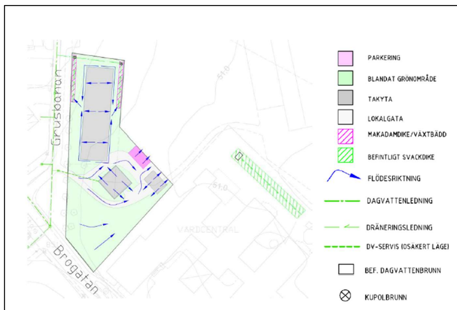
Bilden visar alternativ 2 på förslagen dagvattenhantering (Ramböll, 2018).
