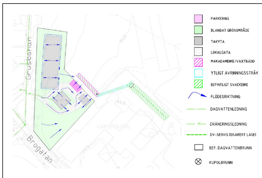
Bilden visar alternativ 1 på föreslagen dagvattenhantering (Ramböll, 2018)
