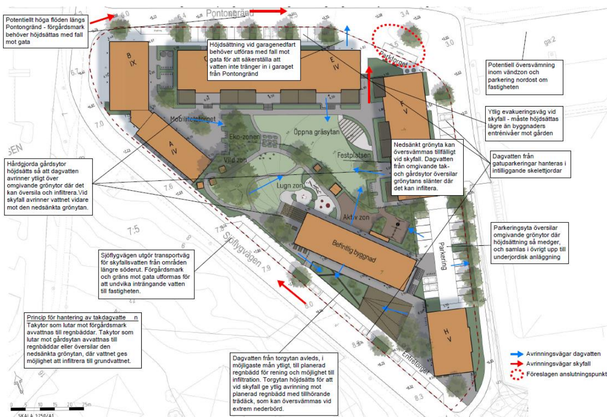
Figur 36. Föreslagen dagvattenhantering inom det södra kvarteret. Bild. Structor.
