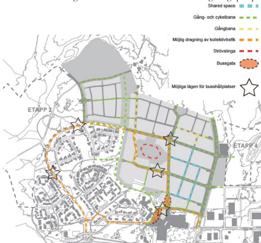
Figur 60. Utdrag ur gestaltningsprogram framtaget 2023-03-07. Kartan visualiserar föreslagna utformning av gång-, cykel- och busstråk. Möjliga lägen för busshållplatser markerat med stjärna. Källa: Tyréns.
