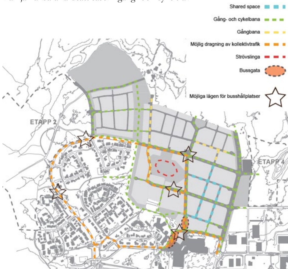
Figur 58. Utdrag ur gestaltungsprogram framtaget 2023-03-07. Kartan visualiserar föreslagen utformning av gång-, cykel- och busstråk. Möjliga lägen för busshållplatser markerat med stjärna. Källa: Tyrens.
