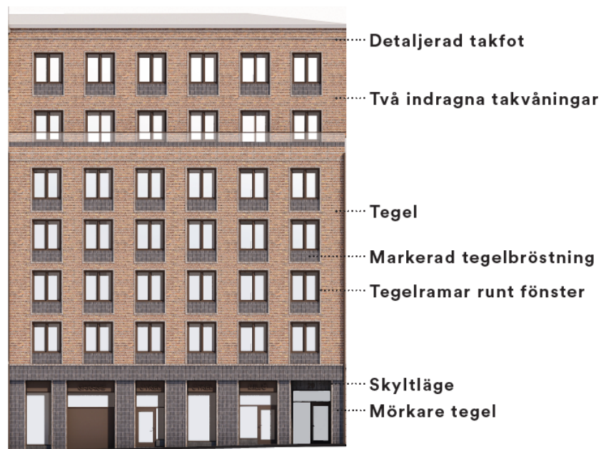
Fasadutsnitt för materialval, kulör och detaljer. (FOJAB)
