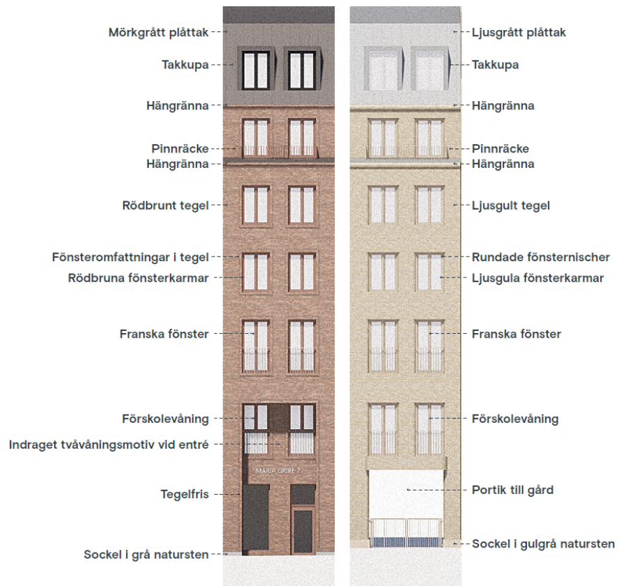
Fasadutsnitt för materialval, kulör och detaljer. (BSK)
