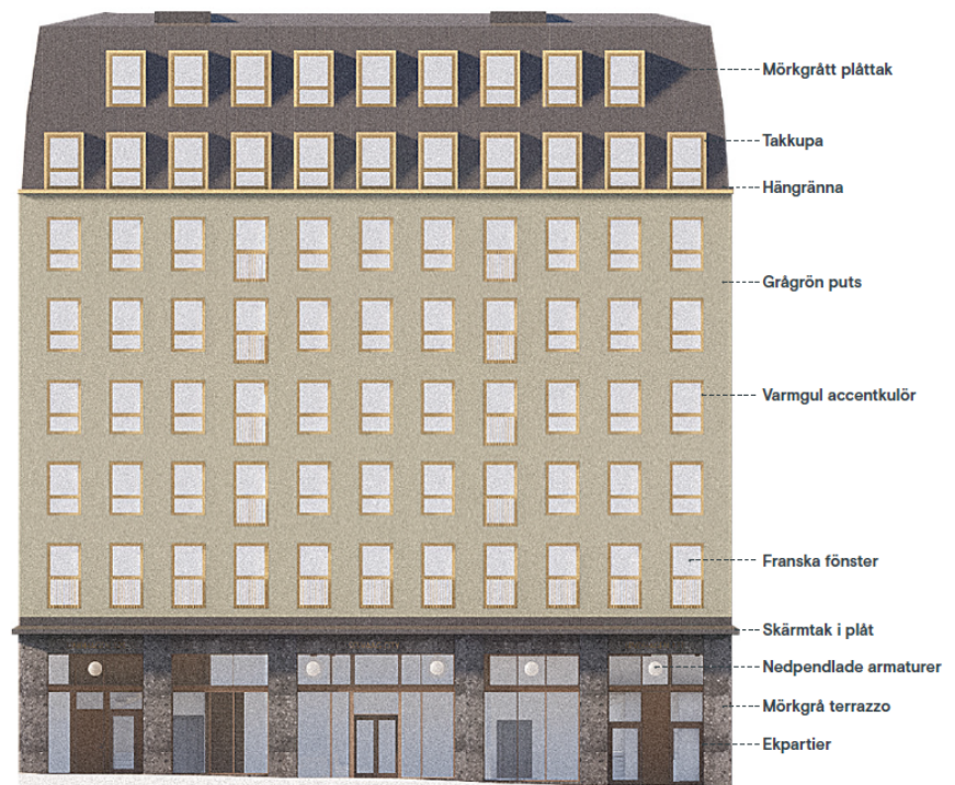
Fasadutsnitt för materialval, kulör och detaljer. (BSK)
