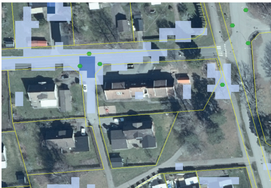
Fig. 5 Utdrag ur skyfallskartan (100-årsregn), Ljusblå områden=grunda vattensamlingar; mörkare blå =djupare vattensamlingar. Grön punkt=rännstensbrunn.
