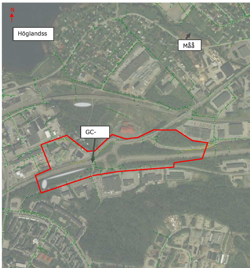
Figur 2 Flygfoto över området med befintliga dagvattenledningar i grönt, planområdet är markerat i rött och damm- och dikessystem representeras av blå figurer.
