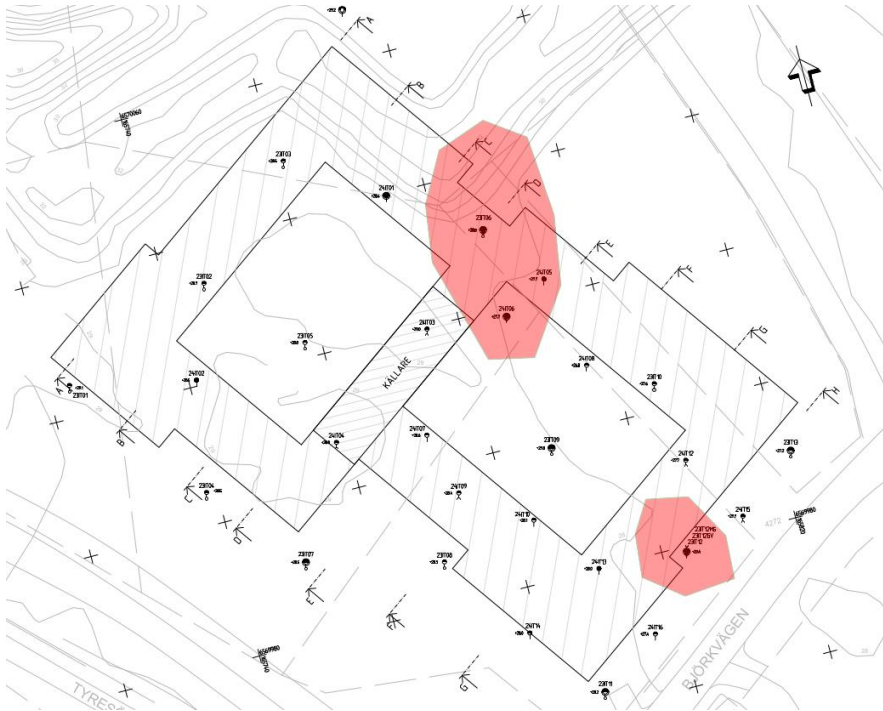
Figur 4 Bedömd omfattning och läge av jordfyllda svackor i berget under planerad byggnad.
