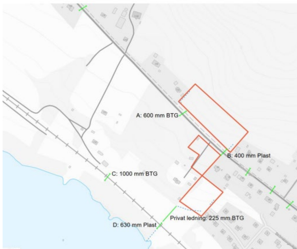
Figur 10. Trummor och dagvattenledning (grön) samt dike (blå streckad linje) i och i närhet av utredningsområdet (SWEKO, 13 augusti 2025)
