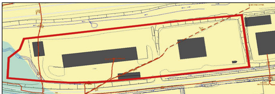
Den "lodräta" röda linjen till vänster i bild är den nya rikskabeln för tele. Den diagonala streckade linjen är "den gamla" släckta ledningen för tele och den tjocka röda linjen markerar planområdet.
