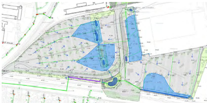
Principen för dagvattenhantering - Skyfall, gällande planområdets norra del - uppställningsytorna.
