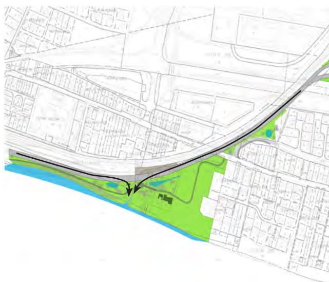
Principen för dagvattenhantering - normal/skyfall gällande planområdets södra del - Hamnleden samt Östra stranden
