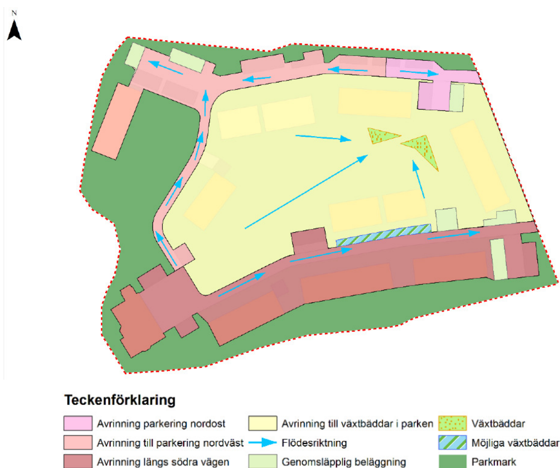
Bild 8. Illustration över dagvattenlösning/växtbäddar (Geosigma).
