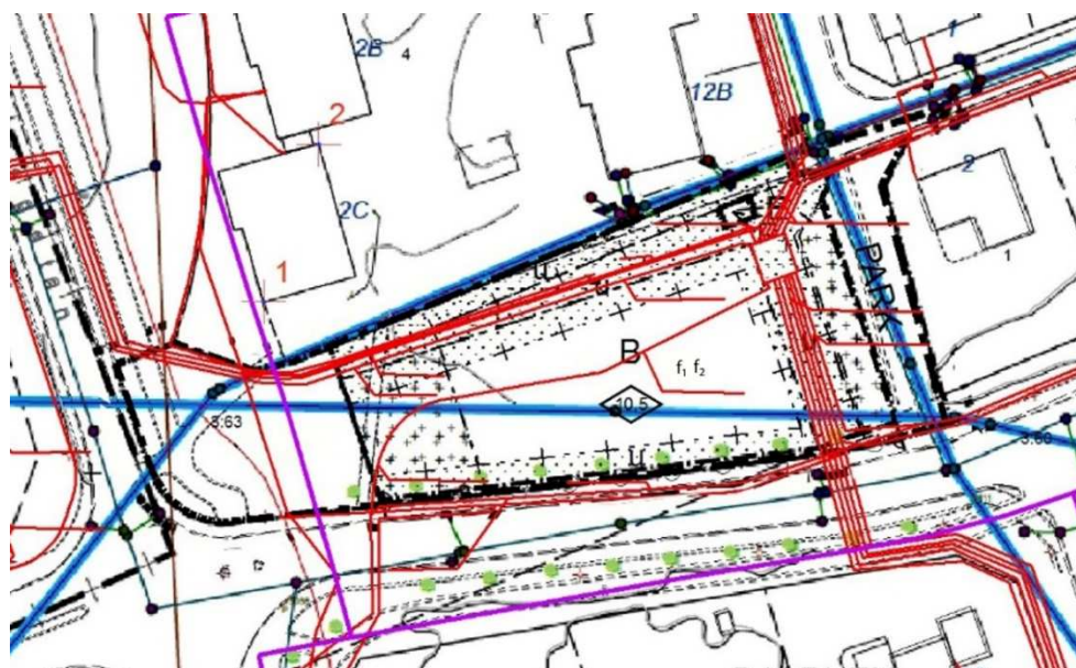
Ledningskarta; VA-ledning (blått), fjärrvärme (lila), gatubelysning (rött)
