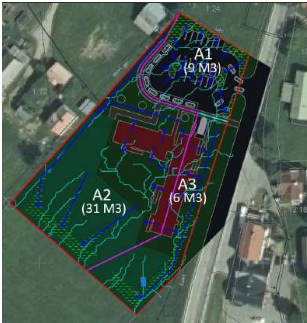
Illustration över föreslagna dagvattenåtgärder, avrinningsstråk, delavrinningsområden (A1-A3) och fördröjningsvolym. (Arctan AB, 2022)
