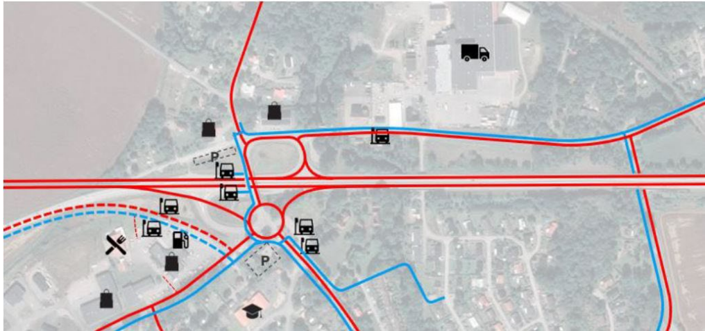
Bild 3. Principskiss över föreslagen utformning för trafikplats Nättraby. E22 och ramper visas med röd heldragen linje liksom befintliga vägar i Nättraby. Blå heldragen linje är gång- och cykelväg längs befintligt vägnät. Streckad linje symboliserar lokalväg (röd streckad) med gång- och cykelväg (blå streckad). Pendlarparkering (P) föreslås söder om cirkulationen och nordväst om E22.
