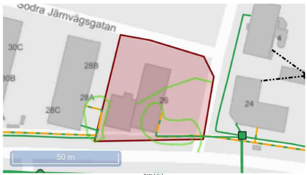
Figur 11. Signalkablar är markerad i grönt. Källa: Ledningskollen.2022-03-02
