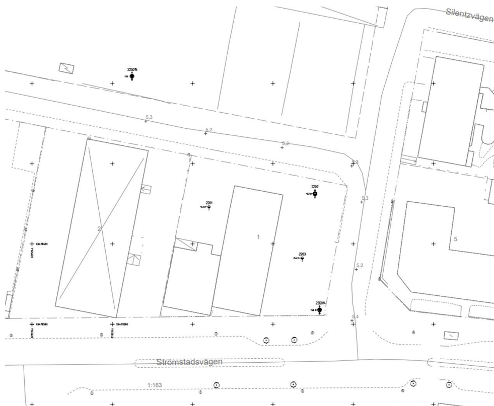
Figur 6. Geotekniska undersökning. Provtagningspunkter 22G014 och 22G015, samt 22G02 där grundvattennivån har mätts är markerad. Källa: Geotekniks undersökning, bohusge uppdrag 21183
