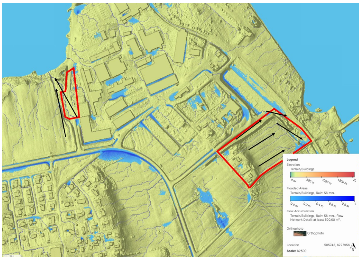
Figur 10. Flödesvägar, ytligavrinning och instängda områden med risk för översvämning i befintlig situation. Baserat på ett 100-årsregn med 30 minuters varaktighet (56 mm). Röd linje markerar utredningsområdena. Svarta pilar markerar de huvudsakliga avrinningsvägarna inom utredningsområdena.
