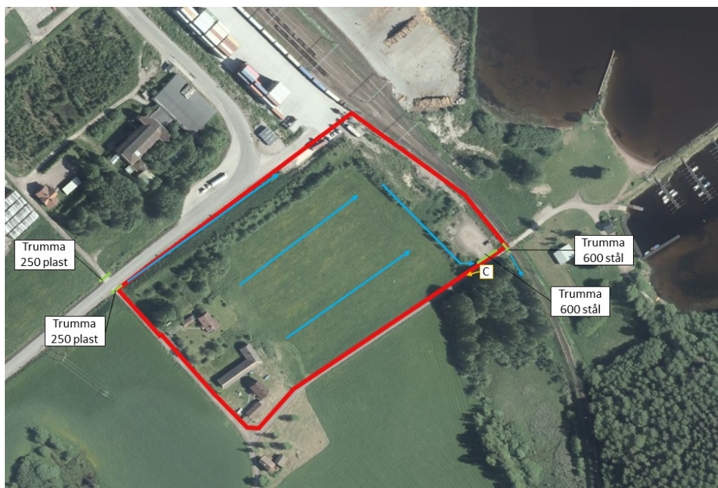
Figur 16. Observationer från platsbesök 2022-10-18. Foton från läge C redovisas i Figur 17 och de gula pilarna markerar i vilken riktning fotot är taget. Röd linje är planområdesgränsen och blå pilar visar huvudsaklig avrinning.
