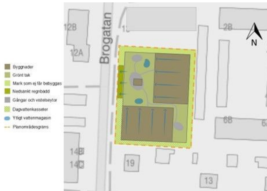
Figur 17: Plankarta över föreslagna dagvattenåtgärder. Källa: Dagvattenutredning, Tyréns (2025)
