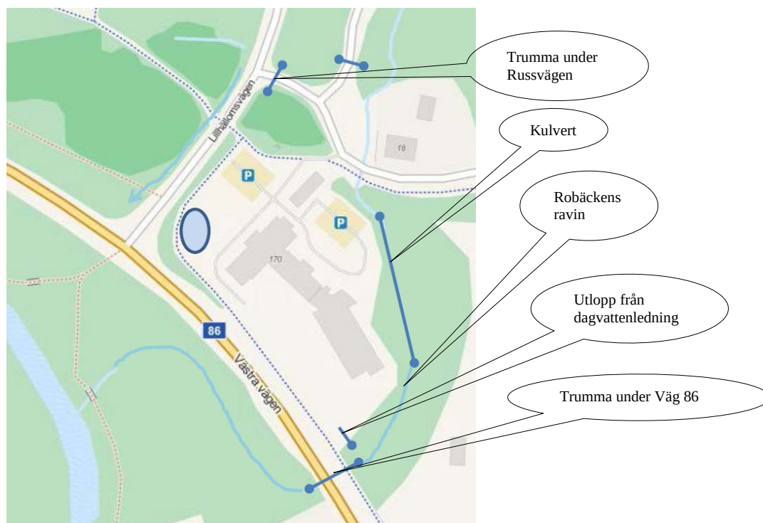
Bild som visar kulvert, Robäckens ravin, utlopp från dagvattenledning och trummor
