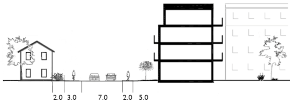
Sektionsritning för Trädgårdsgatan med indragen fasad på fjärde våning.
