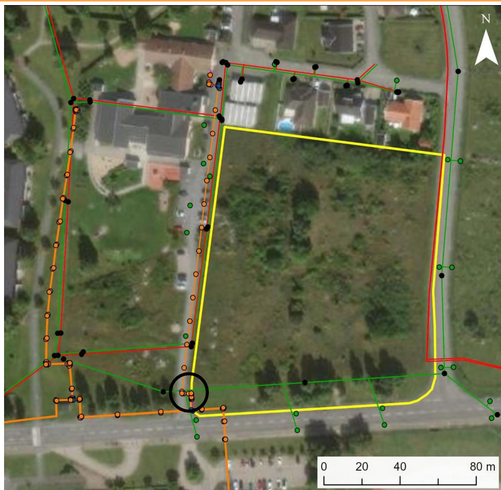
Figur 6. Bevab:s ledningar, däribland dagvatten-, spill- och fjärrvärme kring planområdet (gröna, röda och orange linjer). Svart, cirkel markerar lämplig anslutning till dagvattennätet. Gul linje är planområdets gräns.
