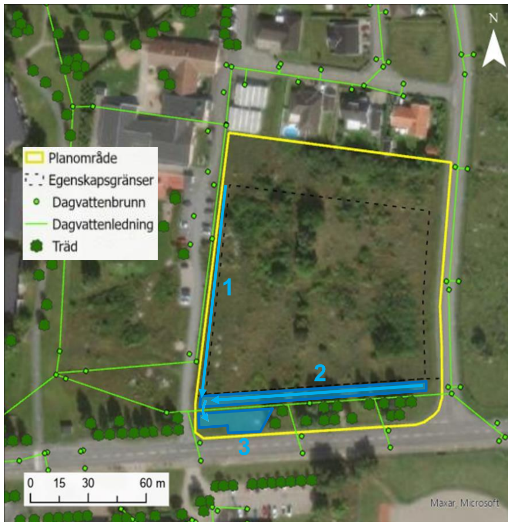
Figur 10. Karta som visar föreslagen dagvattenhantering i form av svackdiken (1 och 2) och torrdamm (3). Svackdiken (2) och torrdammen (3) föreslås utformas för fördröjning av dagvatten.
