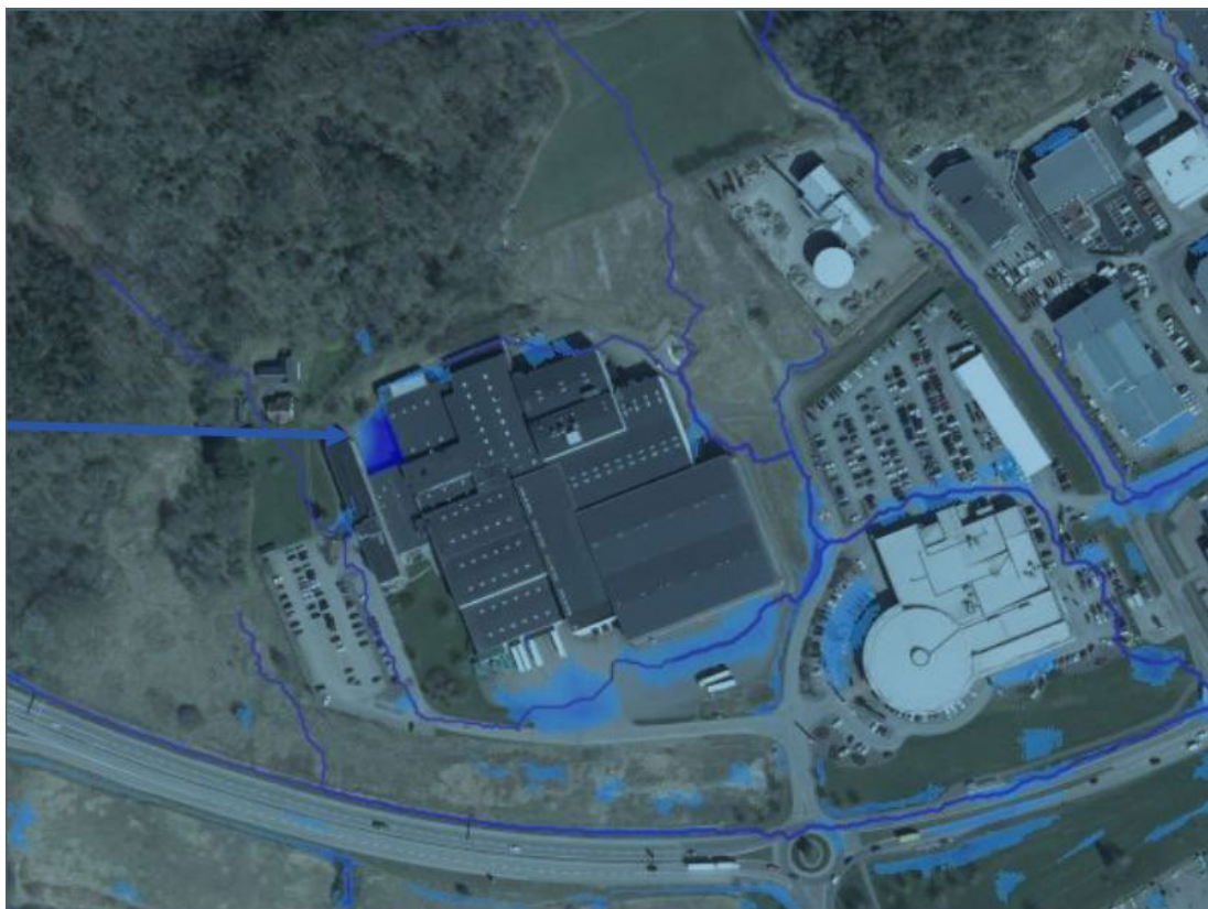
Befintliga rinnvägar och lågpunkter. Scalgo-analys, Kungsbacka Kommun VA
