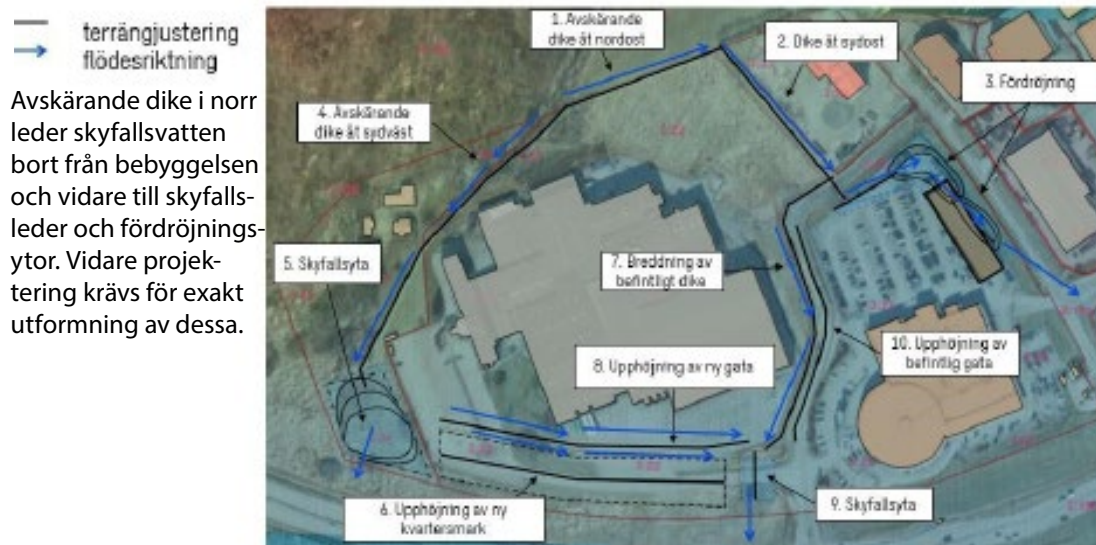
Princip för rinnvägar och fördröjningsytor, Sweco
