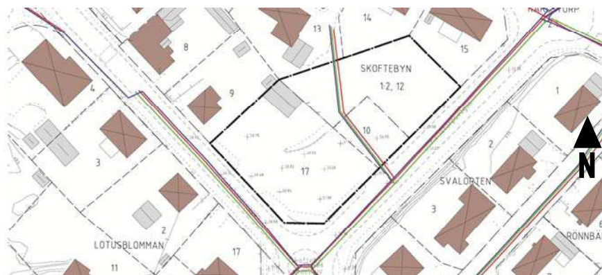
Distributionsledningar för vatten (blå linjer), avlopp/spill (röda linjer) och dagvatten (gröna linjer)
