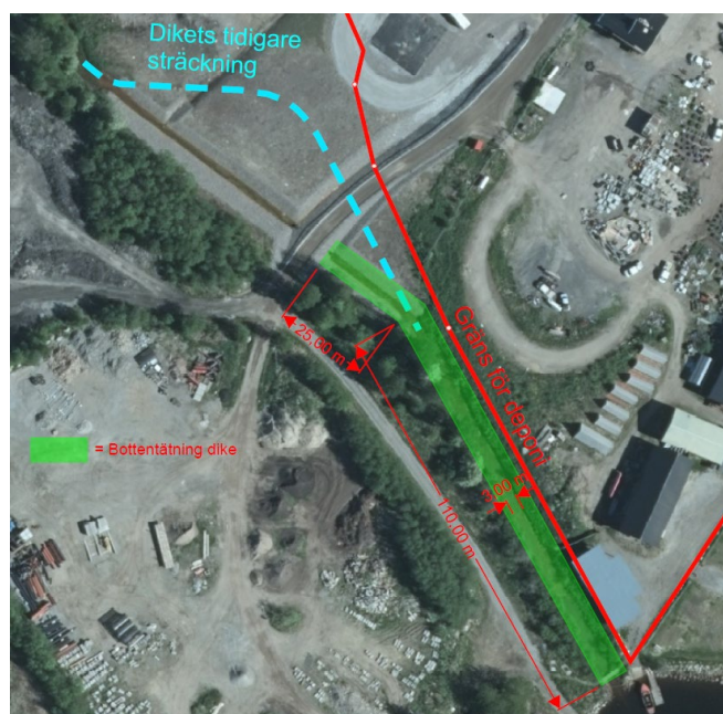
Del av utloppsdiket som ska bottenätas för att undvika kontaminering av dagvatten innan det når recipienten Inrefjärden (som syns till höger i bildens nedra del).
