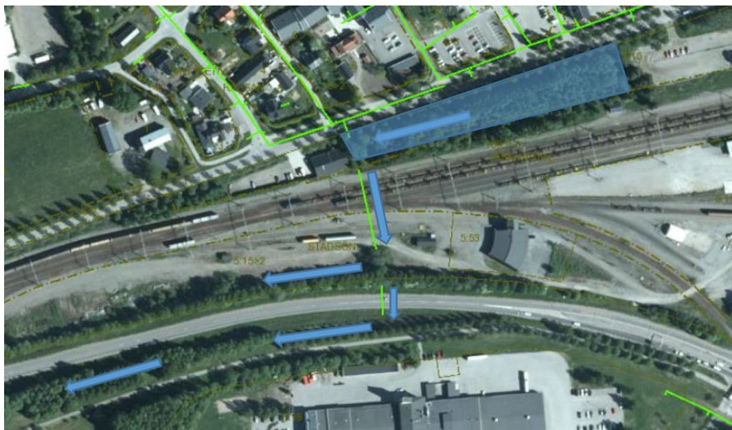
Vattnets väg från planområdet via öppna diken och befintliga trummor under järnväg och väg.
