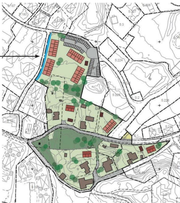
Principskiss dagvattenhantering. Bilden visar exempel på utformning för utökad reningseffekt och avledningskapacitet. Dagvattendike har markerats med blå figur i planområdets nordvästra del. Illustrationsplanen visar samrådsförslaget.
