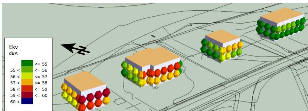
Ekvivalenta ljudnivåer 2040 vid fasad i riktning mot utbyggnadsområdet med utbyggnad.
