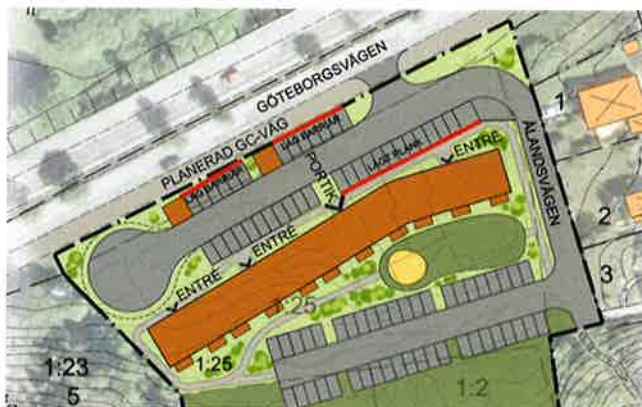
Illustration visar sträckor där någon form av barriär behövs för att avgränsa parkering från gång- och cykelstråk och för strålkastarskydd. Röd markering.
