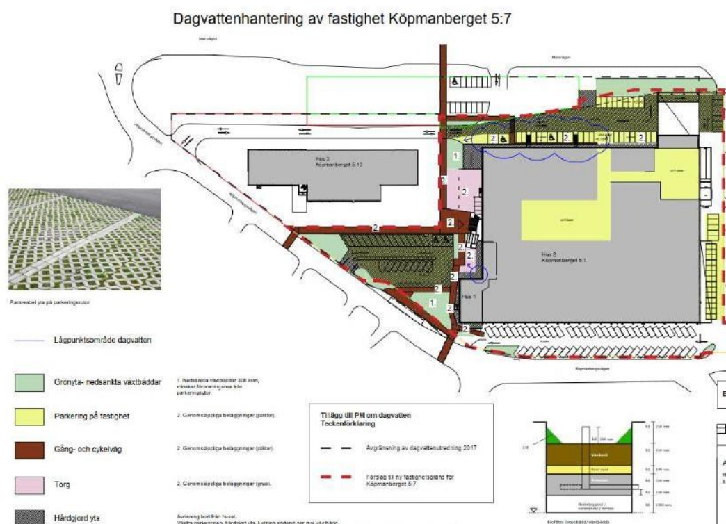
Figur 7. Förslag till systemlösning för planområdet, ur dagvattenutredning Köpmanberget 5:7, Sweco 2017-10-27. OBS, den illustrerade gång- och cykelvägen mot Malnvägen har utgått ur detaljplaneförslaget. Observera även att dagvatten inte får ledas ut på parkmarken norr om fastigheten, där gatans dagvatten behöver ombändertas. Därför behöver en del av parkeringsplatserna i planens norra del nyttjas för nedsänkta växtbäddar.
