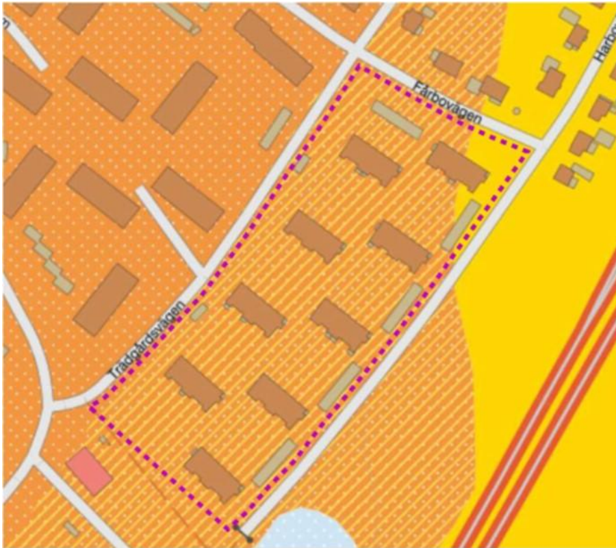
Figur 15. Kartbild över rådande geologi inom det markerade planområdet. Glacial sand med underliggande glacial lera markeras i orange färg med gula linjer, medan gult utgörs av glacial lera.
