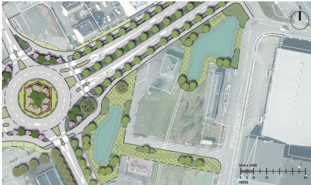
Dagvattenmagasin 1 sydöst om ny cirkulationsplats med dike från Bromsaregatan samt dagvattenmagasin 2 i anslutning till Långebrogatan. Källa: Sigma Civil
