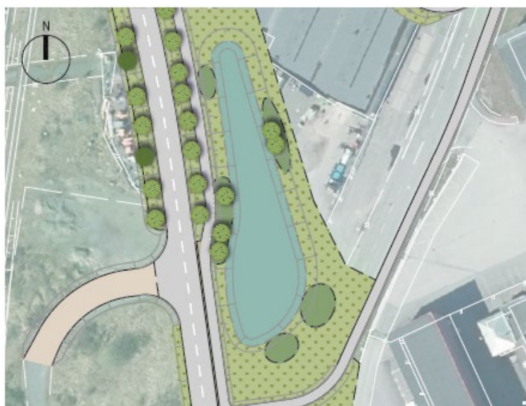
Dagvattenmagasin 3 intill nya Hedentorpsvägen. Källa: Sigma Civil
