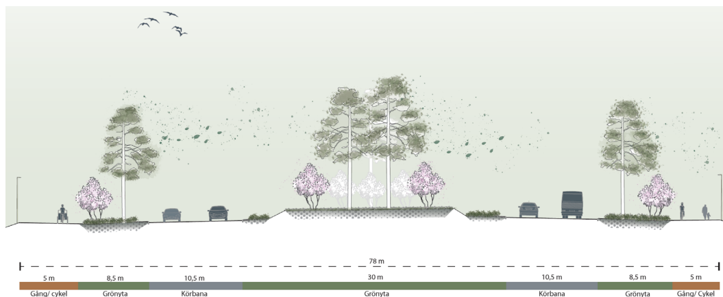
Principsektion cirkulationsplats Källa: Sigma Civil
