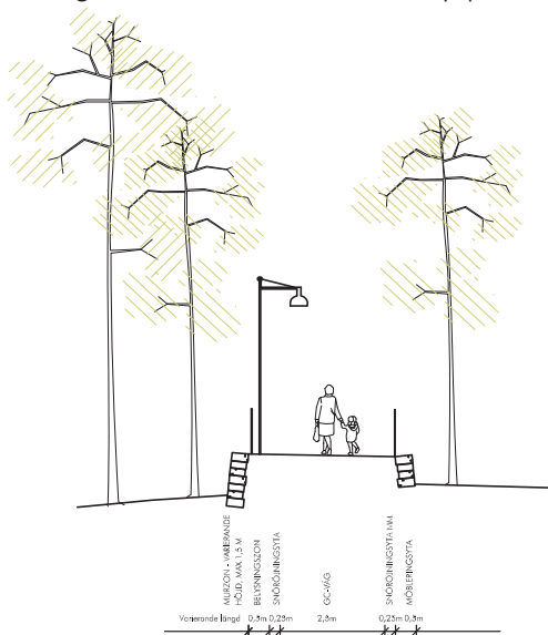
Sektion uppbyggd gc-väg över mark. Skala 1:200.
