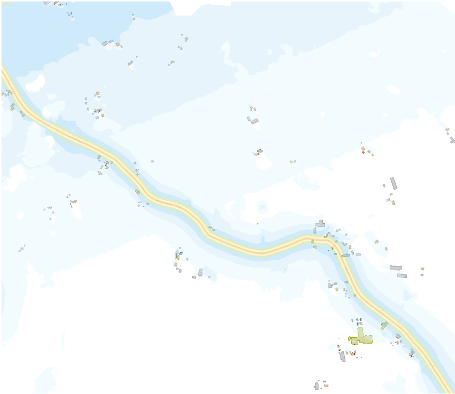
Figur 20. Översiktlig trafikbullerkartering för väg 626, ekvivalent ljudnivå. Mörkblå färg motsvarar 45-50 dBA. Grön färg motsvarar 50-55 dBA.
