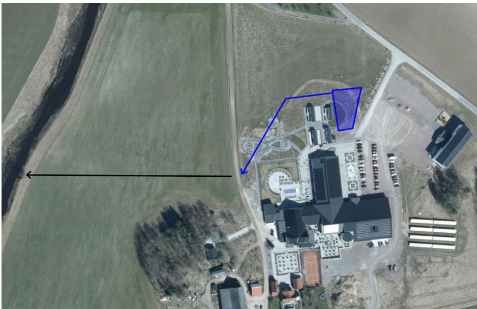
Figur 24. Blå yta och linje visar schematisk dagvattenhantering inom planområdet efter utbyggnad. Svart linje visar ungefärlig sträckning för befintligt täckdike västerut.
