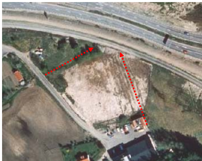
Öppna diken inom och i anslutning till planområdet, röda pilar i avvattningsriktning.
