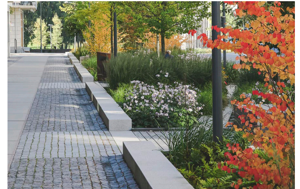
Exempel på dagvattenhantering med nedsänkta planteringar i Norra Djurgårdsstaden
