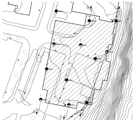
Mätpunkter gjorda inför kommande tillbyggnad
