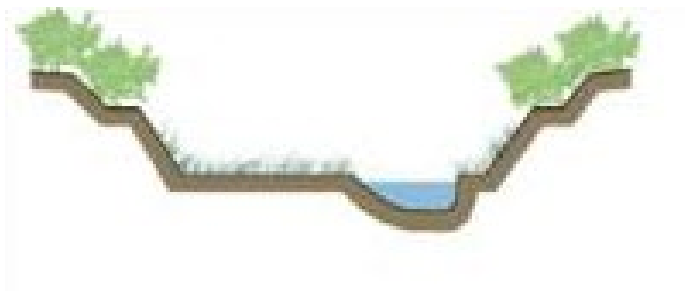
Figur: Sektion utvisande ensidigt svämplan.
