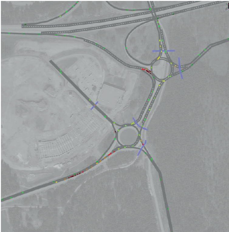
Bilden ill vänster. Ögonblicksbild med prognosflöden med föreslagen utformningsalternativ av korsningen (från Trafikanslysen, WSP, 2020-10-20)
