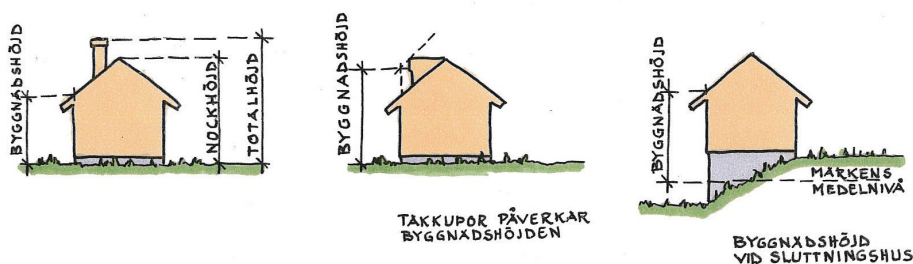
Förenklat diagram av beräkning av byggnadshöjd
