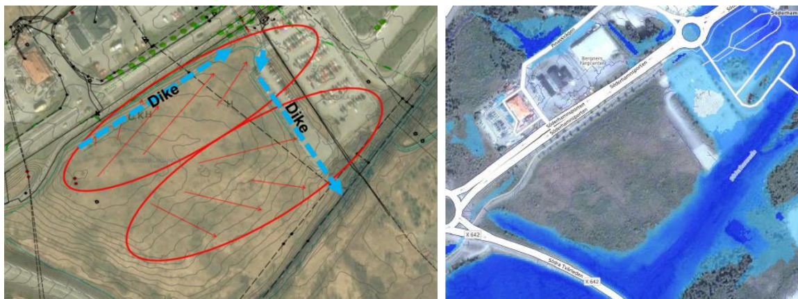
1 Tv Dagens avrinning från planområdet. Th översvämningsrisk. Mörkblå områden kan ha vattendjup på minst 50 cm under ett 100 mm regn. Källa: VA och dagvattenutredning Tyrens AB 2020.
