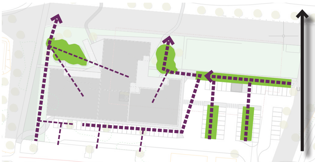
Förtydligande Skyfallsstråk och dagvattenfördröjning samt rening. Lilla pilar: Flöde vattenmassor skyfall; Gröna ytor: Fördröjnings- och reningsdammar.
