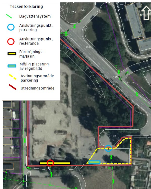
Figur 3 – Placering av kommunala dagvattenledningar samt förslag på placering av dagvattenmagasin, anslutande ytor och regnbäddar.
