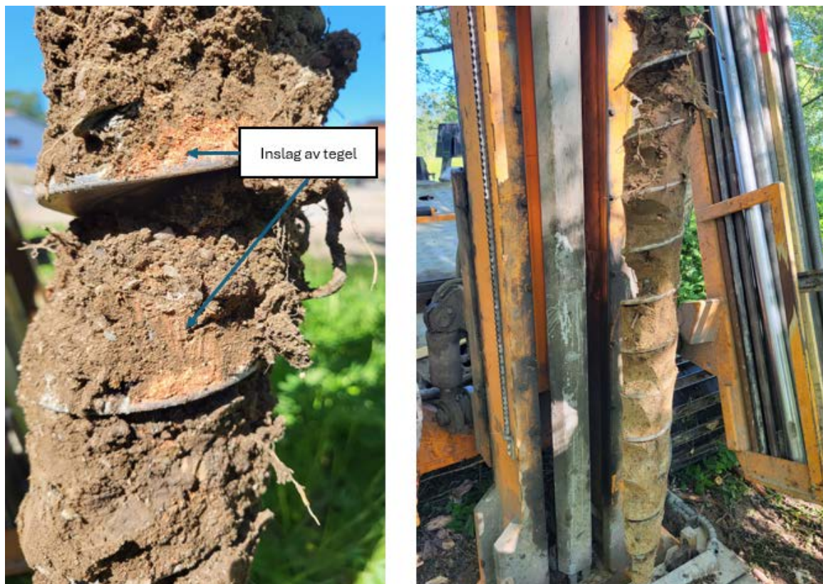
Figur 6. Till vänster Skr2406 där inslag av avfall påträffades 0,5 meter under markytan. Till höger Skr2405 som bestod av drygt 0,5 meter mulljord på torrskorpelera.
