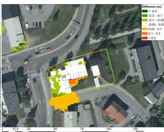
Bild 26: Bilden visar förändringar i översvämningssnivåer med den tillkommande bebyggelsen gentemot dagsläget.
