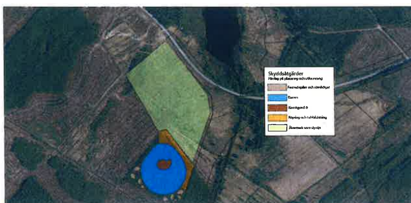
Figur 26 Illustration med förslag på placering och utformning av dagvattendamm inom kvartsmarken.
