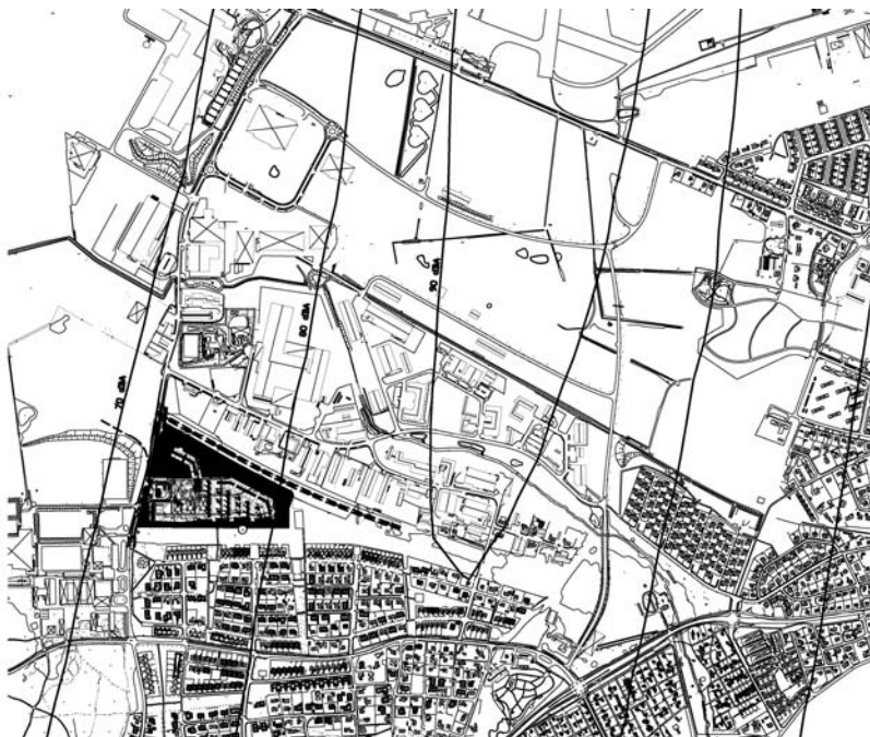
Figur 9. Flygbullerkurvor (70, 80 och 90 dB(A)) för Fokker 100 (dimensionerande flygplanstyp) vid starter söderut. Bullerutredning TR 2002-266 R04 (WSP, Enviromental, Stockholm, 2002).
