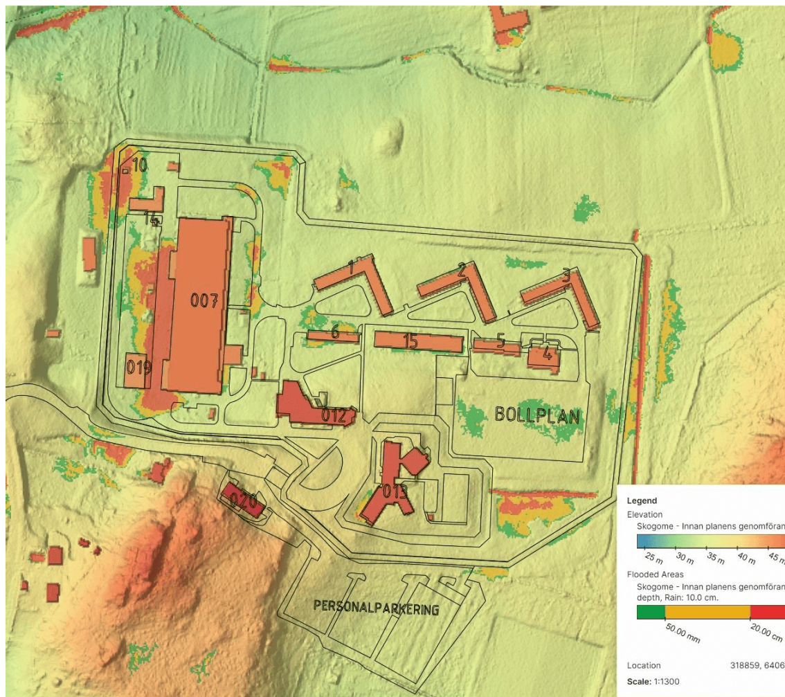
Figur 25: Vattendjup i vattensamlingar som bildas vid skyfall, befintliga förhållanden. Grönt område: 0-5 cm, Gult område: 5-20 cm, Rött område: >20 cm.
