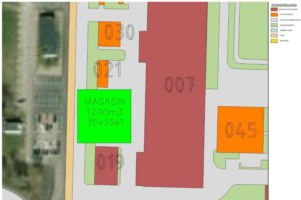
Figur 40: Magasin dimensionerat för ett skyfallscenario
