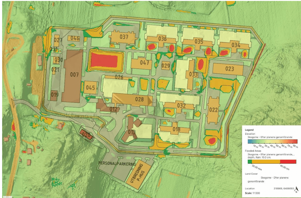
Figur 41: Vattendjup i respektive vattensamling vid ett 100 års regn. Figur skapad i SCALGO. Grönt område: 0-5 cm, gult område: 5-20 cm, rött område: >40 cm. Höjddata: projekterad mark.
