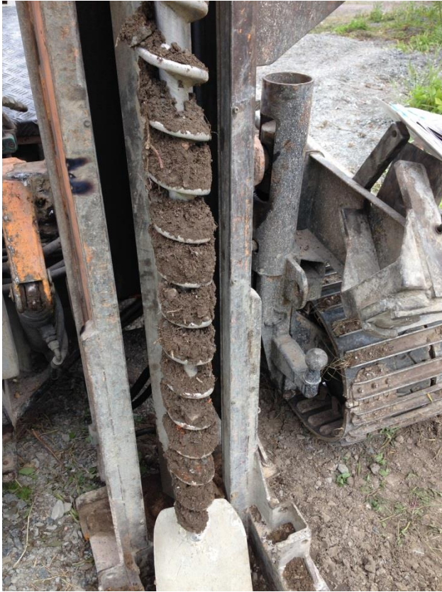
Foto 3: Provpunkt 14GV10. Fyllnadsmaterial med inslag av tegel.
