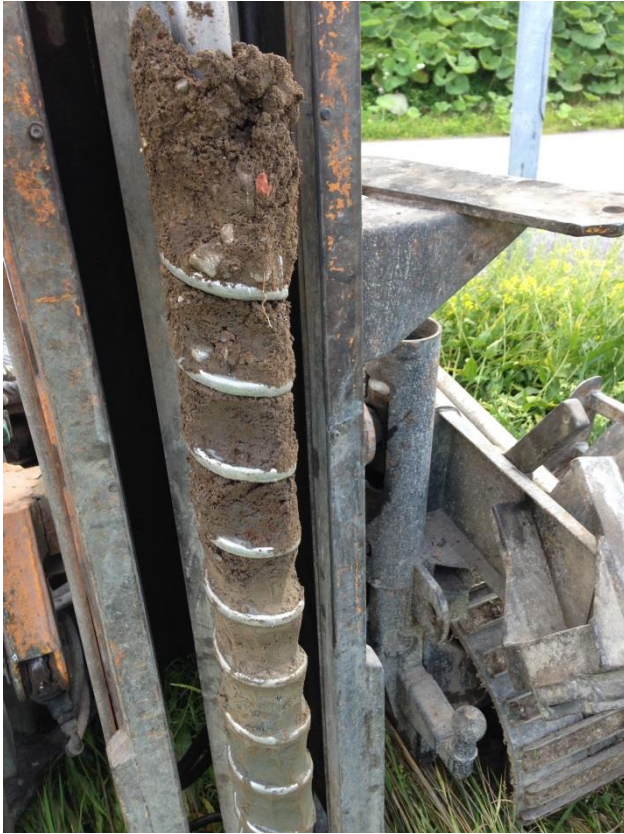
Foto 5: Provpunkt 14GV15. Fyllning över sand.
